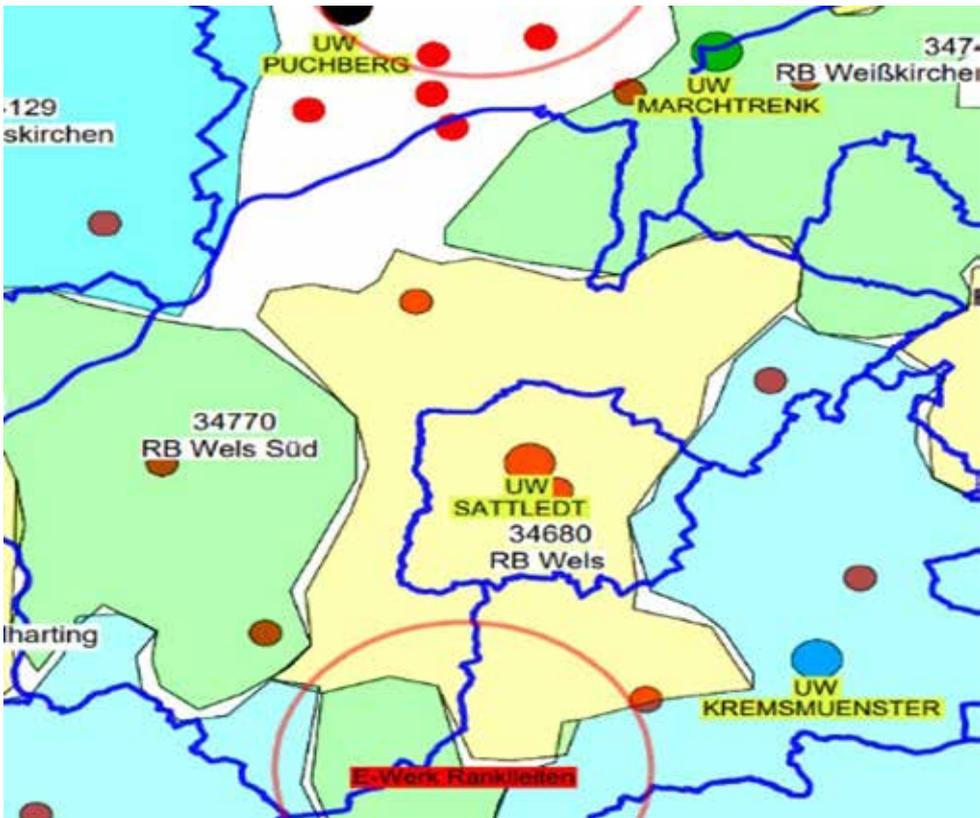
Karte: Auf der Karte ist gelb hinterlegt zu sehen, welche Bereiche in und rund um Sattledt mit Strom aus dem Umspannwerk Sattledt versorgt werden.
