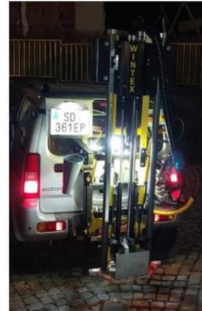
Fahrzeug mit automatischem Probenstecher.
